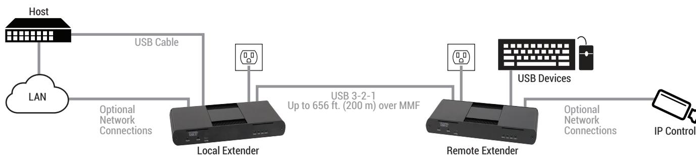
FIGURE 3-1. TYPICAL INSTALLATION
